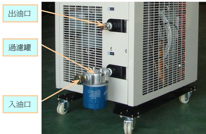
3. 齒輪箱請加入 R-32 齒輪油。首先注入齒輪油至油位鏡中線，啓動主軸油冷機，讓油冷機與管線中充滿齒輪油，再繼續添加齒輪油，需注意油冷機停止時，油量不可超出油位鏡中線。新機一年內，每三個月更換一次齒輪油，以後則每半年更換一次齒輪油。
